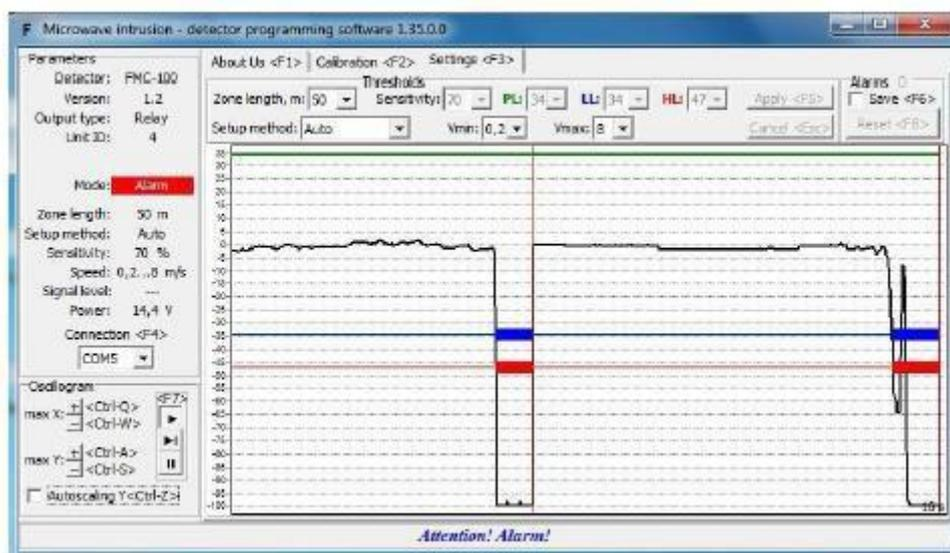
Вы можете изменить минимальную и максимальную скорость движения вероятного нарушителя “Vmin” и “Vmax” скорректировав ее по реальной обстановке охраняемой зоны обнаружения.
