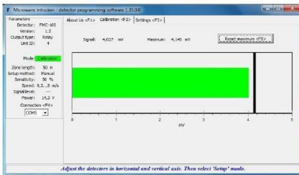
Перемещая по горизонтали и вертикали сначала Передатчик, затем Приемник добейтесь максимальных показателей уровня напряжения. Шкала mV
