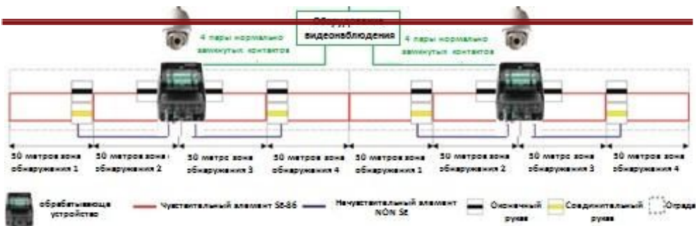
Рис.23 ИЗВЕЩАТЕЛЬ ПОЛОСА-4 УСТАНОВЛЕН НА ОГРАЖДЕНИИ. ВЫСОТА ОГРАЖДЕНИЯ 2 МЕТРА, ДЛИНА УЧАСТКА 50 МЕТРОВ.
