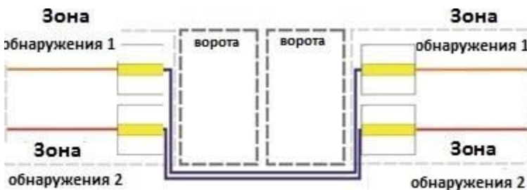
Рис.25 ПРОХОЖДЕНИЕ ВОРОТ. ПРОКЛАДКА НЕЧУВСТВИТЕЛЬНОГО КАБЕЛЯ ДЛЯ ИСКЛЮЧЕНИЯ ВОРОТ ИЗ ЗОНЫ ОХРАНЫ
